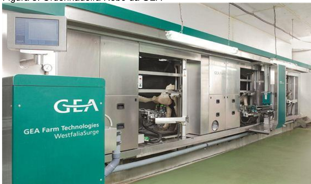
Figura 5: Ordenhadeira Robô da GEA
