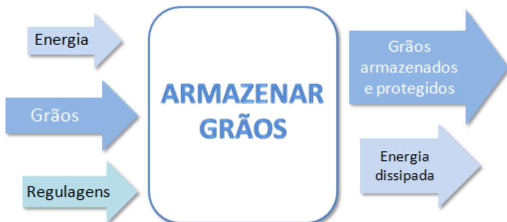
Figura 8 - Função Global do tanque graneleiro
