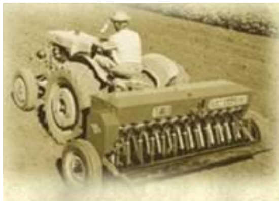
Figura 3. Semeadora e adubadora com rodas articuladas. Fonte: Fankhauser SA (2011).
