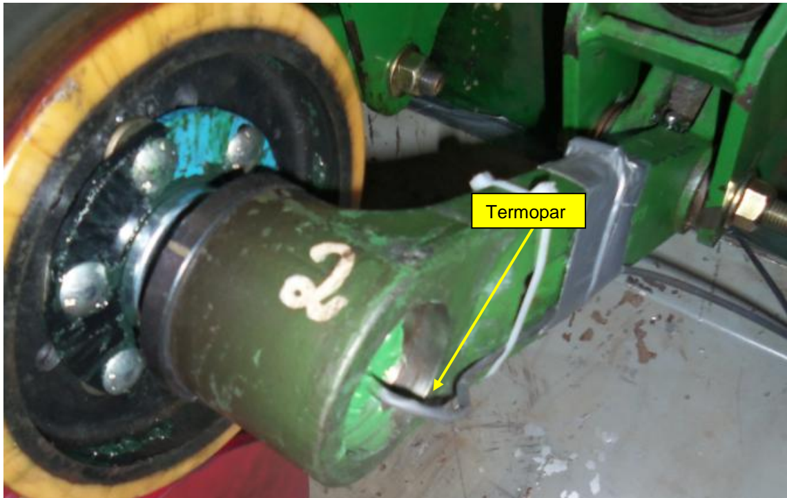
Figura 5: Termopar inserido na bucha e fixado com silicone.
