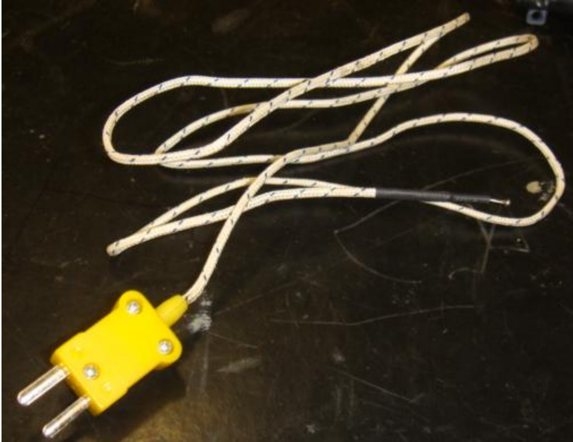
Figura 3: Sensor termopar tipo K utilizado em bancada de teste.
