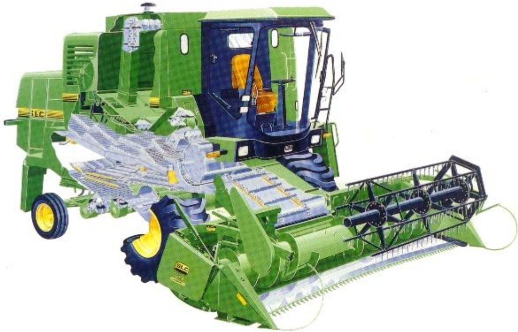
Figura 3: Colhedora de grãos com cilindro de trilha e saca-palhas. Fonte: UFV (2011)
