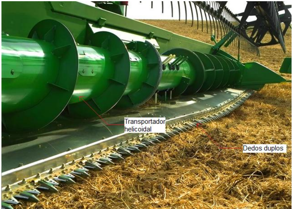
Figura 6: Detalhe do transportador helicoidal e barra de corte. Fonte: John Deere (2011)
