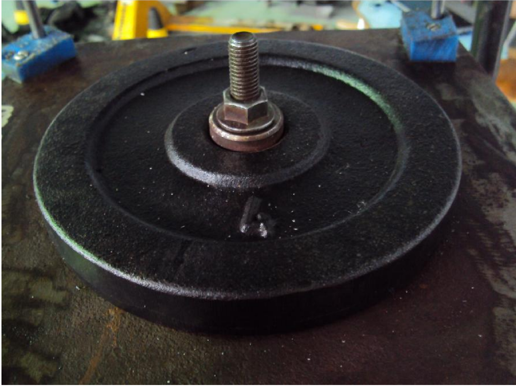
Figura 8 – Corpo de prova composto pela massa da base e da anilha
