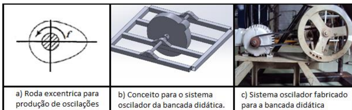
Figura 10 – Sistema oscilador da bancada didática
