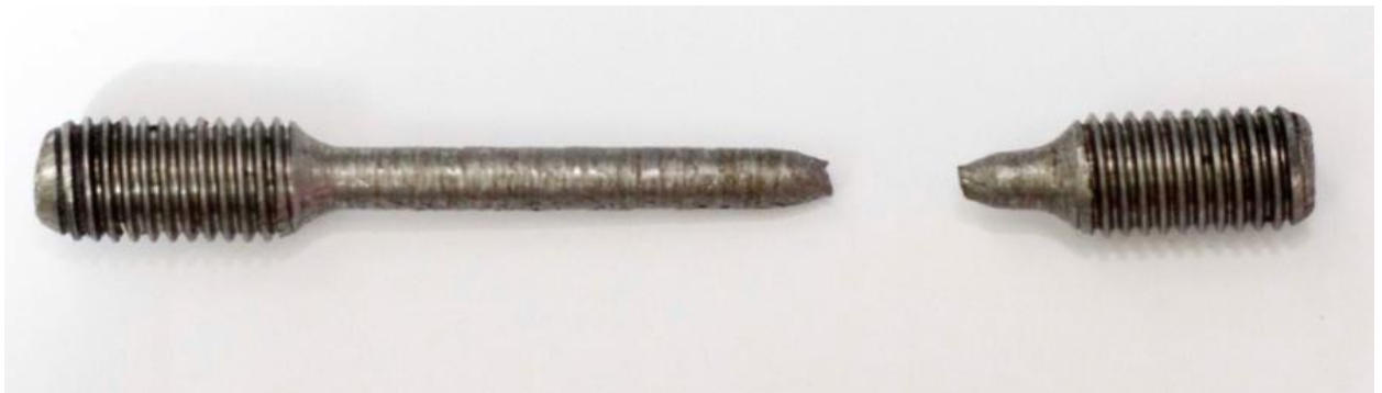
Figura 18 - Corpo de prova aço SAE 1020 Ø 6,35 mm rompido.
