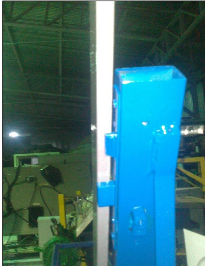
Outra medida adotada foi a colocação de uma proteção em torno da máquina, a fim de evitar que nenhuma parte do corpo do operador possa entrar em contato com alguma parte móvel da mesma.
