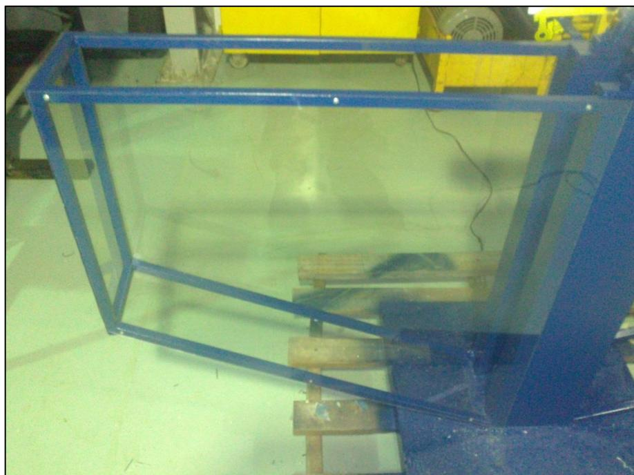
Conforme a Figura 21, uma das laterais também foi protegida colocando-se policarbonato, para que o corpo de prova não fosse projetado para fora da máquina, na tentativa de evitar um eventual acidente.
