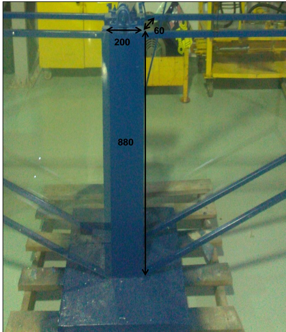
Foi estabelecida a largura das colunas de 60 mm. A partir da tensão de cisalhamento ( $\sigma$ ) do concreto, e por meio da equação 23, foi possível descobrir o comprimento necessário da coluna para suportar a força de impacto de 2.539,49 N (aplicando-se a mesma força que o pêndulo sofre no momento do impacto).
