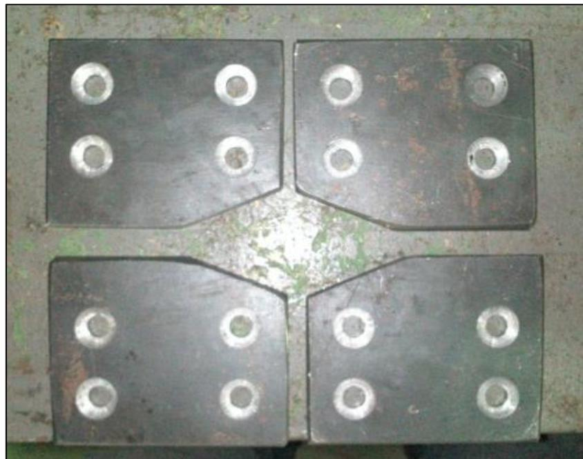
Para fixação das chapas, foram feitos furos roscados no martelo e furos chanfrados nas chapas, onde as mesmas foram fixadas com parafusos allen cabeça escareada M8 x 15 mm, assim não causando interferência do martelo.
