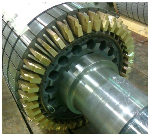
Figura 4 – Rotor de barras com anel de curto
