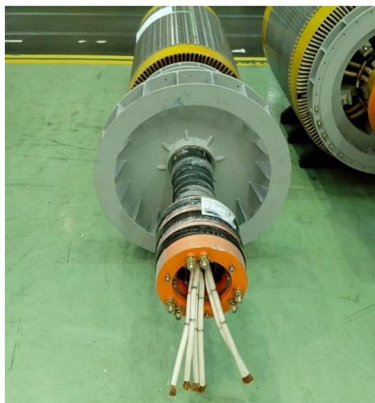
O acesso ao circuito interno só é possível por meio de anéis de deslizamento e escovas de carvão que permitem a conexão elétrica de resistências externas ou reostatos. Enquanto o estator é alimentado na tensão e frequência nominais da rede elétrica, a conexão externa de resistências ligadas ao circuito do rotor possibilita o aumento considerável do torque de partida da máquina, facilitando o acionamento de cargas com elevada inércia ou alto torque de arranque (CHAPMAN, 1999).
