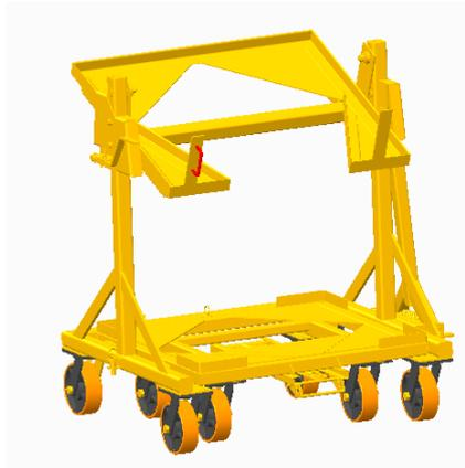
Na Figura 5 pode ser visualizada a ilustração do *tilt rack* grande o qual é utilizado para itens armazenados em container grande e aramado grande com dimensões externas de 1750 x 1120 x 1400 milímetros (comprimento, largura e altura).
