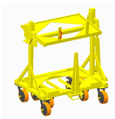
A Figura 4 mostra o desenho de um *tilt rack* médio sendo utilizado para container médio, aramado pequeno, *pallet* de KLT e colapsável pequeno tampa baixa com dimensões externas de 1350 x 1050 x 1400 milímetros (Comprimento, largura e altura respectivamente).
