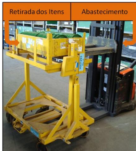
Movimentação: o dispositivo foi desenvolvido de forma que permite o transporte de três formas diferentes, onde pode ser com a parte superior e inferior acopladas, somente a parte superior e por fim somente a parte inferior. Mais detalhes podem ser observados nas Figuras 7 e 8.
