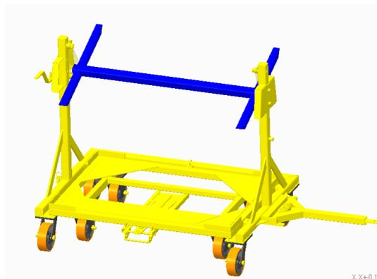
Para chegar ao entendimento de como a estrutura estaria dimensionada para a sua atual aplicação, o *software* considera alguns fatores principais que caracterizam o material afim de trazer o mais próximo da realidade esta análise virtual sendo destacados o tipo de material, limite de escoamento, resistência a tração, módulo elástico, coeficiente de Poisson, massa específica e módulo de cisalhamento. Valores e características estão listados na Tabela 3.
