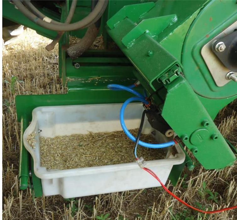
A avaliação da precisão da coleta foi realizada através de uma análise de um representante do grupo que realiza as coletas na empresa. Observou-se que as vedações de borracha fornecem um completo isolamento do dispositivo minimizando perdas, Figura 23. O tempo de coleta da amostra é preciso em razão de que o mesmo é controlado automaticamente através do relé temporizador, Figura 24.
