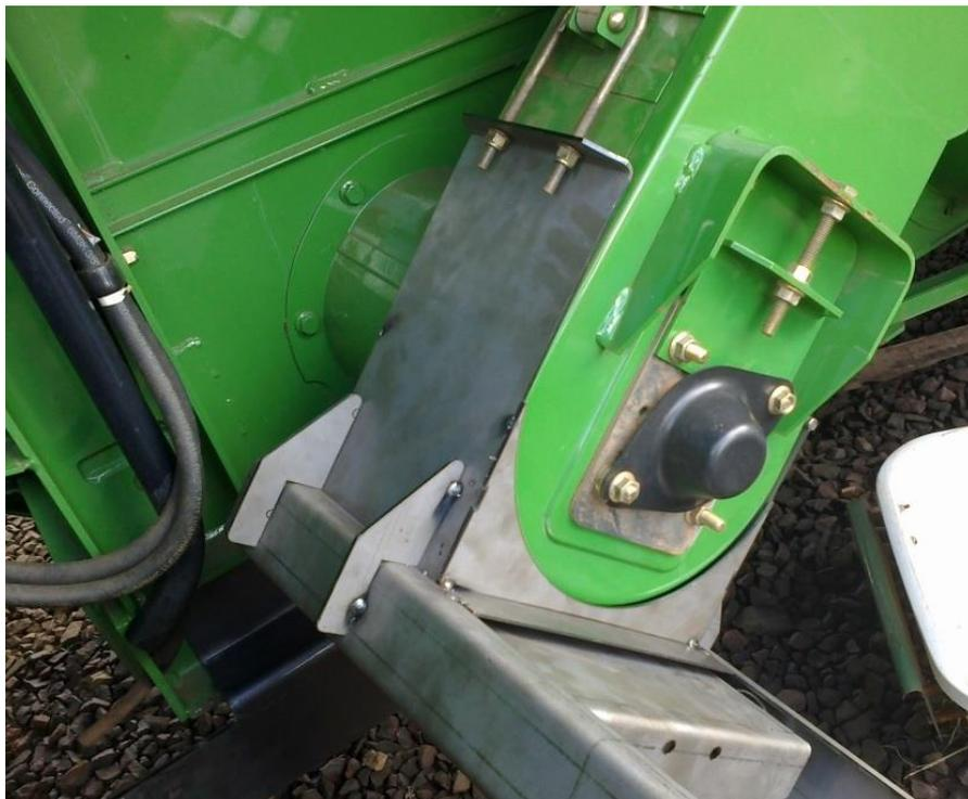
Não havendo necessidade de alteração, foi finalizada a solda do dispositivo e realizado a pintura do mesmo. Posteriormente foi montado o sistema elétrico e o sistema pneumático conforme Figura 14.
