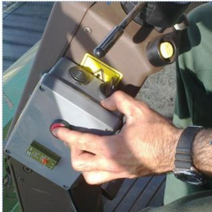
Ao acionar o sistema através da botoeira ocorre a abertura da janela de coleta conforme Figura 21, dessa forma o produto que seria encaminhado para o elevador passa a ser direcionado para a bandeja coletora onde permanece armazenado, Figura 22.
