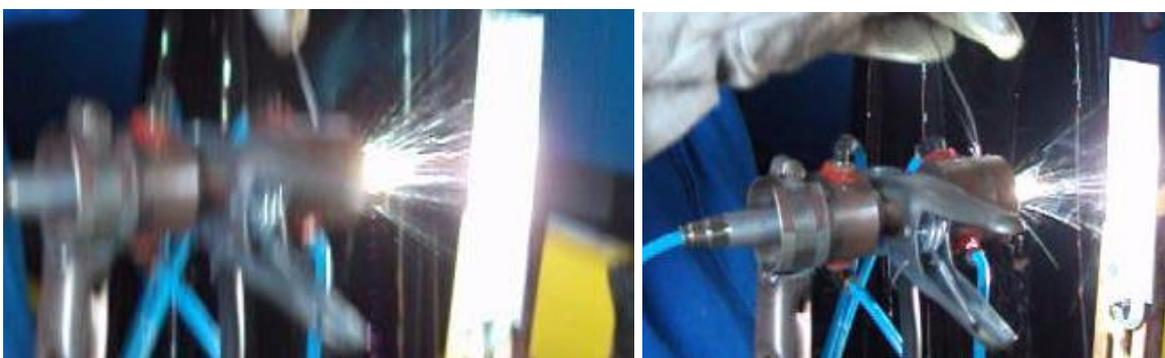
Após a resolução de todos os problemas, a tocha foi avaliada e novos testes foram realizados. A tocha de plasma foi desmontada para verificação do desgaste de seus componentes internos, onde foi verificado que os principais componentes afetados foram a arruela de adaptação e o anodo, conforme Figura 21.
