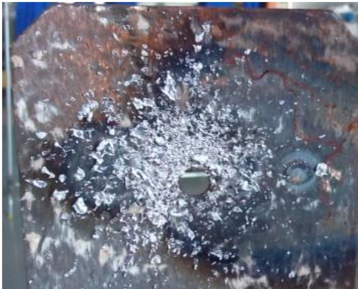
Em outro experimento realizado, o corpo de prova utilizado foi de material alumínio sendo o material de adição estanho em formato de fio. Os parâmetros utilizados neste experimento foram os mesmos do experimento com o corpo de prova de aço SAE 1020. Ao final do experimento verificou-se que houve deposição de material sobre o corpo de prova utilizado, tornando a superfície do mesmo rugosa porém mantendo um formato regular, conforme mostrado na Figura 23.
