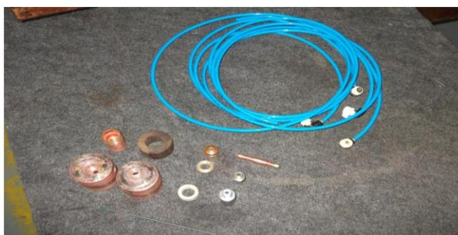
Após a fabricação de todas as partes constituintes da tocha de plasma, foi dado início ao processo de montagem da mesma. Os componentes da tocha de
