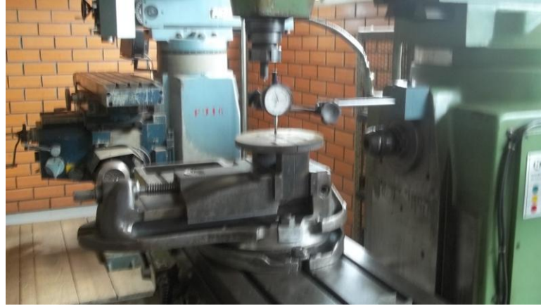
Figura 9 - Sistema de fixação sendo alinhado com a máquina.
