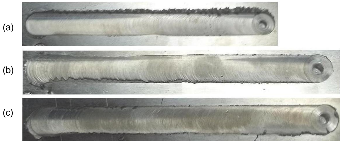
Figura 12 - Vista superior dos corpos de prova soldados com diferentes velocidades de soldagem.
