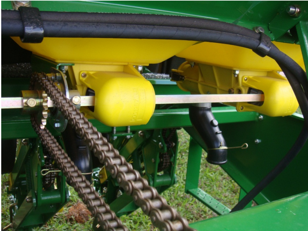
Figura 5 - Eixo de acionamento dos dosadores de fertilizante da plantadeira
