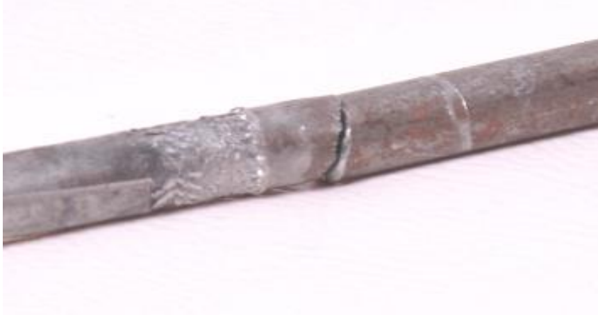
Figura 20- Ruptura em eixo
