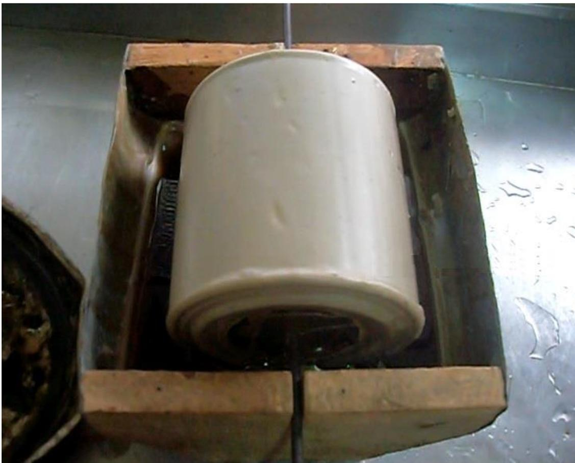
Com a construção e funcionamento do protótipo foi possível descobrir que de fato a cera irá se aderir ao cilindro laminador (no caso do teste a lata de tinta), e as temperaturas de funcionamento, a cera deve ser mantida a 65 °C para permanecer líquida e o cilindro deve estar com 18 °C para a cera solidificar em suas paredes externas.
