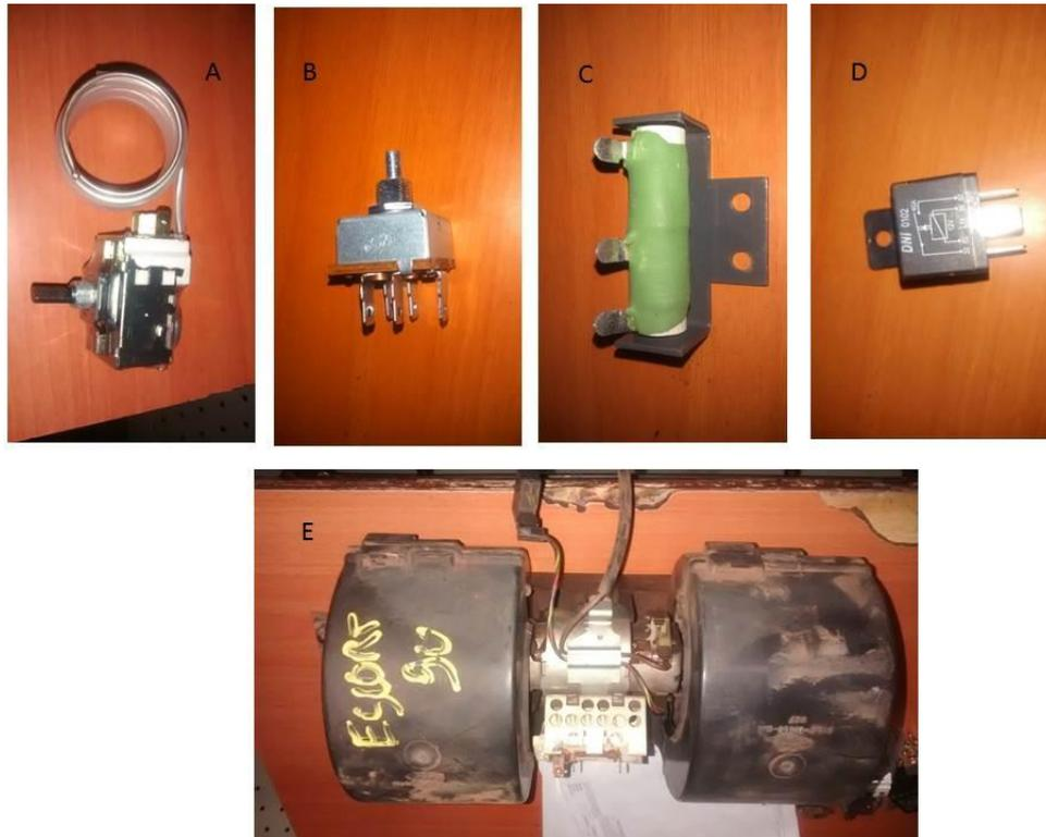
Figura 12 (A): A função do termostato é controlar o compressor, desligando e ligando o mesmo, assim que atingir a temperatura de  $-3\text{ }^{\circ}\text{C}$  dentro do evaporador, evitando o congelamento do mesmo e desgaste do compressor;
