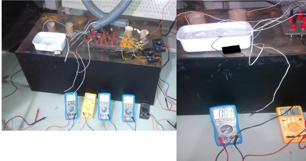
Após a calibração, foram coletados os dados resultantes nos multímetros, nos instantes em que a temperatura do termômetro estava marcando  $-0,5$ , e  $0,5$  °C. Os multímetros informaram os dados em volts. Dessa forma, necessitou-se uma conversão para poder obter o resultado dos testes aplicados na bancada em °C. Na Figura 17 pode-se observar os dados encontrados durante a calibração dos termopares.
