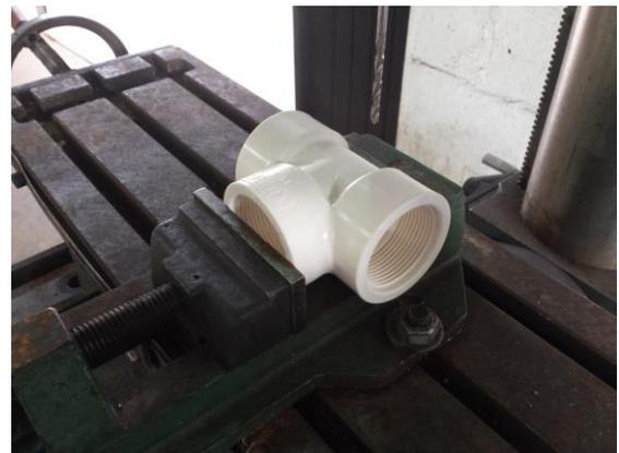
Para possibilitar a montagem do medidor de vazão, fez se necessário a remodelagem da canalização em PVC da bancada, conforme apresenta Figuras 15 (a) e (b), permitindo instalação do medidor após o rotâmetro e em serie com a bomba e com um sistema de *by-pass* para possibilitar sua anulação em caso de modificações ou manutenção do equipamento desenvolvido.
