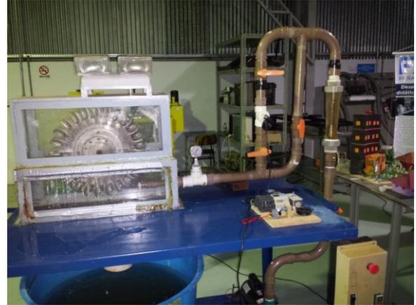
Com o medidor de vazão já posicionado na canalização, foram realizados alguns testes na linha para identificação de possíveis vazamentos.
