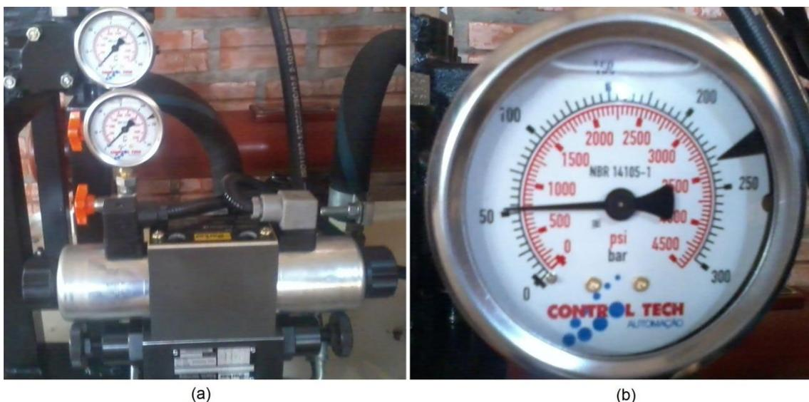
Na Figura 11 (a) é possível ver os manômetros das duas linhas de pressão instalados no sistema, a válvula direcional de duplo solenoide e a válvula controladora de fluxo. Já na Figura 11 (b) é possível ver um manômetro indicando uma determinada pressão durante um teste realizado.
