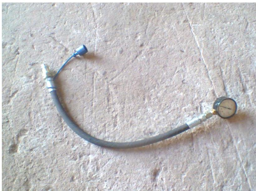
Foram realizados diversos testes, em diferentes pontos. Os valores coletados após a válvula de alívio estar regulada para abrir em 180 Bar. O valor de 180 Bar era obtido através dos manômetros da figura 11, enquanto o manômetro da figura 12 indicava em um ponto da linha um valor diferente que
