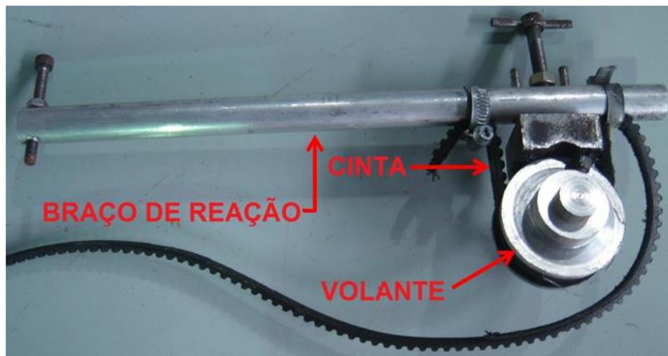
O freio de Prony foi acoplado na extremidade do eixo da turbina, fazendo com que o seu braço de reação permanecesse ao lado (em uma posição radial) e este apoiado a superfície do dinamômetro (Figura 8).
