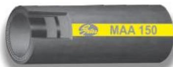
**Aplicação:** Recomendada para aplicações de condução e descarga de água e ar comprimido. Utilizada geralmente na indústria, construção civil e agricultura. Apresenta excelente resistência à abrasão e intempéries. Não indicada para uso com óleo ou derivados de petróleo.
