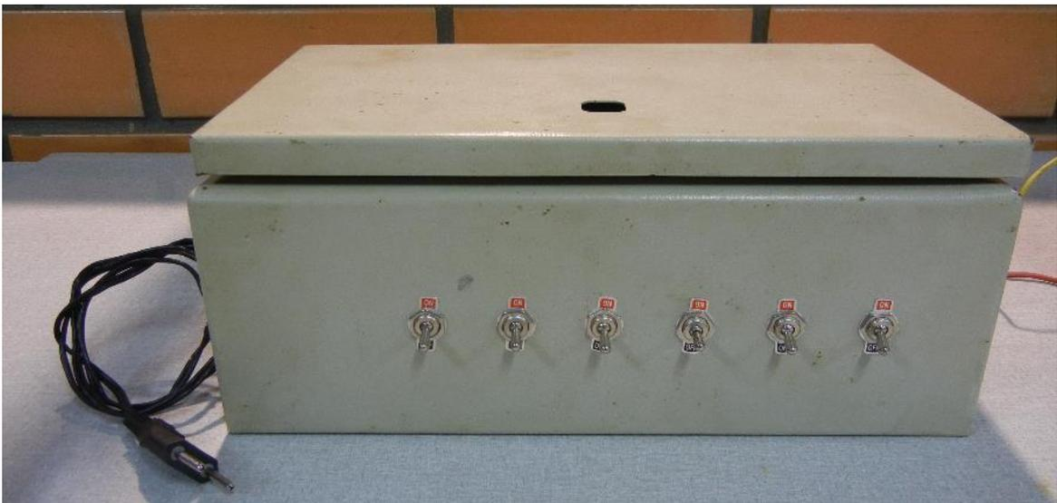
Inicialmente, o dispositivo foi configurado para realizar a soldagem das amostras com uma capacitância de 5 mF, ligando-se assim apenas uma das chaves seletoras. Para cada aumento de capacitância necessário, mais uma chave seletora foi ligada, adicionando 5 mF ao valor anteriormente configurado. Após a escolha da energia de soldagem, torna-se necessário fixar os componentes a serem soldados no dispositivo de forjamento.
