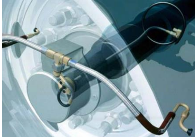
Figura 1: Cubo de roda com sistema pneumático auto pressurizador Fonte: Souza (2013).
