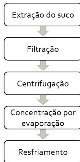
Figura 3: Etapas do processo de concentração de sucos utilizando o método da evaporação. Adaptado de MACHADO, 2010
