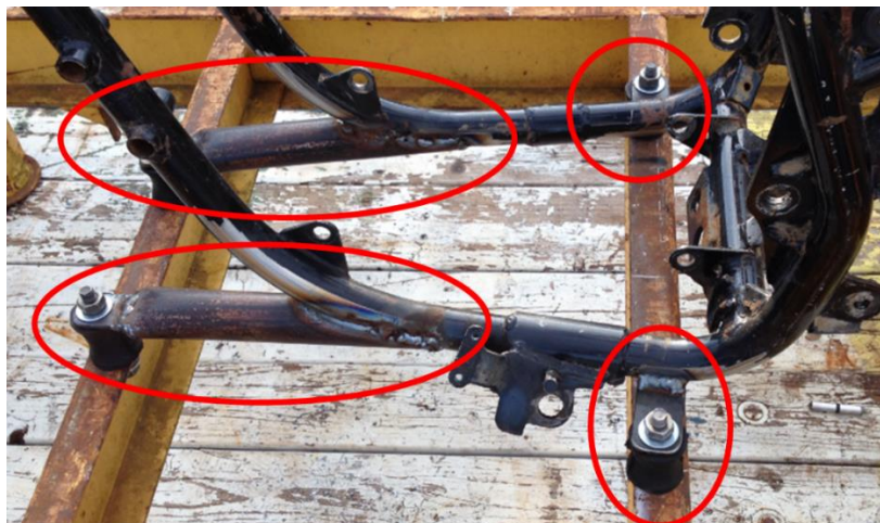
Figura 9 - Suportes de fixação do chassi na bancada.
