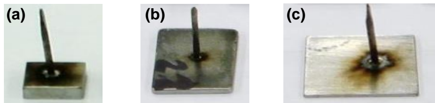
Figura 13: Corpos de prova soldados. (a) chapa base aço SAE 1045 com Energia média 1 de 63 J; (b) chapa base aço DOMEX 700MC com Energia média 2 de 128 J; (c) chapa base aço DOCOL DP 1000 Energia média 3 de 192 J.
