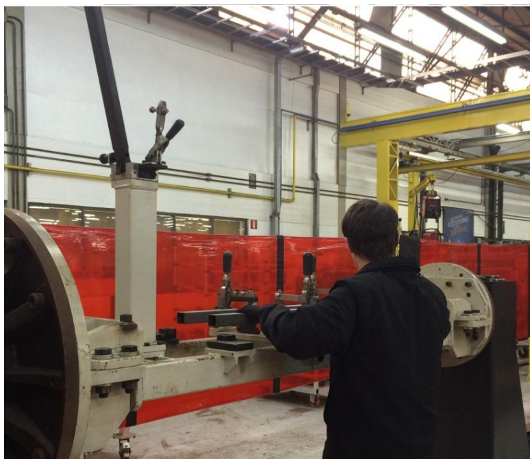
Figura 11: Posicionamento dos elementos a serem soldados.
