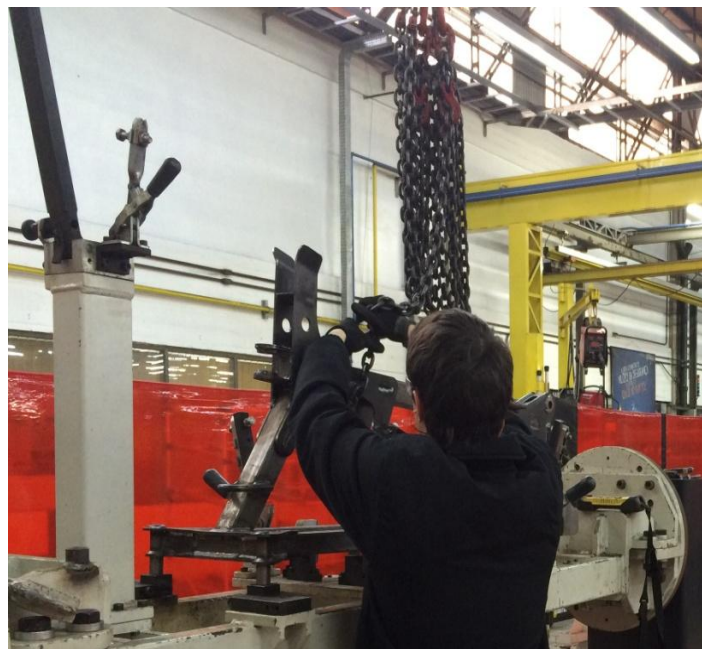
Figura 15: Retirada da peça soldada do dispositivo.
