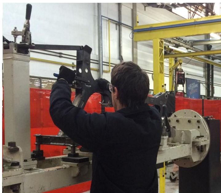
Figura 13: Colocação dos grampos de aperto.
