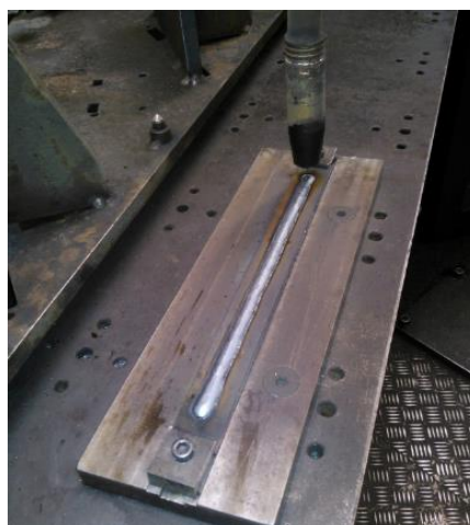
Figura 14: Cordão depositado sobre o corpo de prova fixo no dispositivo
