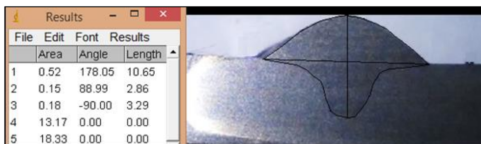
Figura 16: Corpo de prova otimizado para arame 1,0 mm
