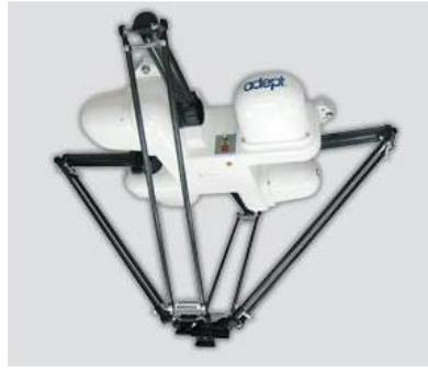
Figura 5: Robô Delta. Fonte: (M.A.R, 2015)
