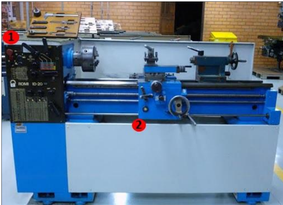
Figura 8: Botão de emergência no torno universal.
