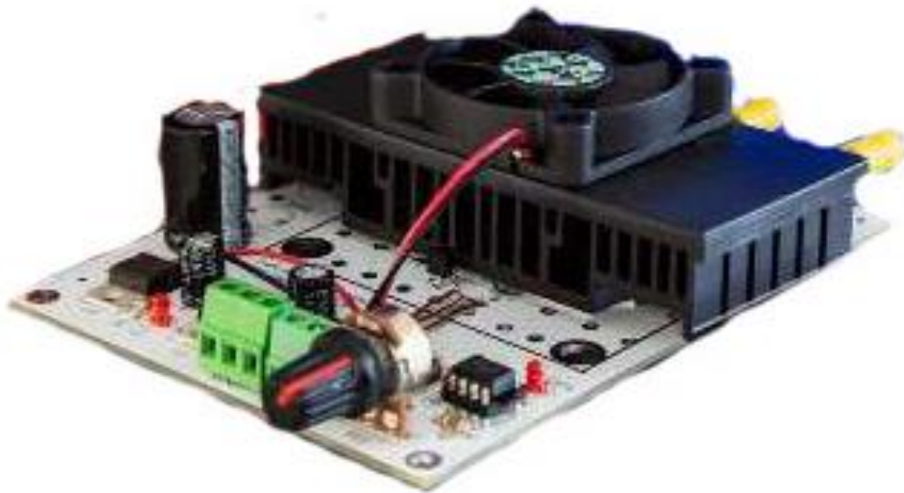
Figura 5: PWM de 0 a 45 Amperes.
