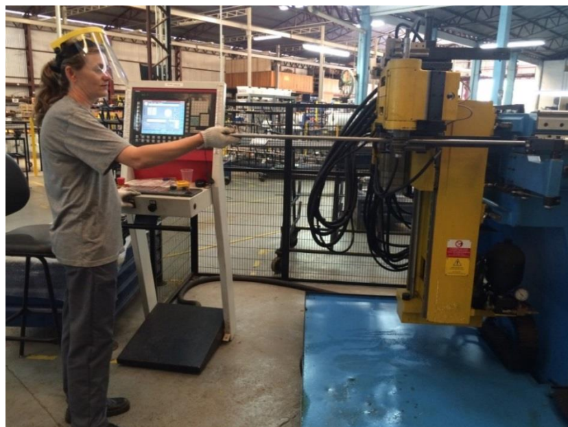
Figura 12: Tubo hidráulico sendo colocado na máquina para realizar a conformação.
