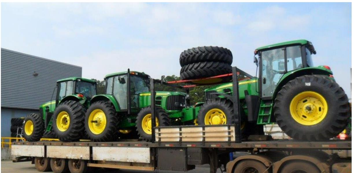
**ANEXO E – PROTÓTIPO DA EMBALAGEM PARA EMBARQUES DE TRÊS TRATORES, SENDO DOIS COM PNEUS DUPLADOS**
