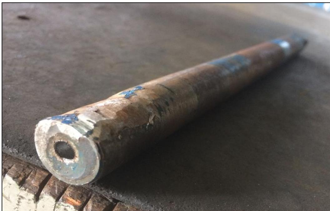
Com o intuito de resolver esse problema, foi necessária a fabricação de um novo eixo com as mesmas medidas e dimensões. Após adaptado o novo eixo à máquina, tornou-se possível realizar a coleta de dados com o potenciômetro normalmente, conforme pode-se observar o novo eixo na Figura 14.
