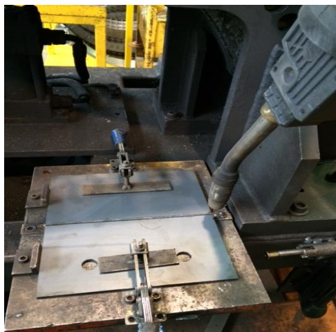
Figura 6 - Chapas montadas no dispositivo e posicionadas para a soldagem.
