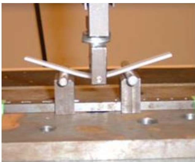
Figura 5 - Ensaio de dobramento.
