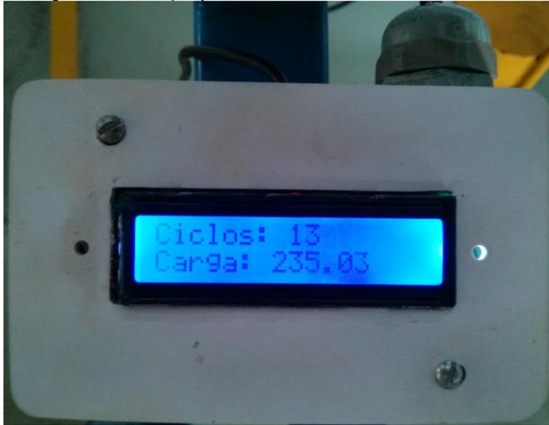
O display LCD mostra os dados durante e após o ensaio. Porém quando este outro ensaio é iniciado o display zera e começa a exibir os dados do novo ensaio. Entretanto a proposta do trabalho abrange a utilização de outra ferramenta útil, o Excel. Com a utilização da Macro desenvolvida pelo Roberto Valgolio, chamada Arduino\_Excel, é possível carregar esses dados em uma planilha do Excel.
