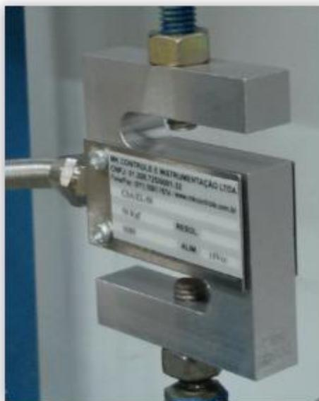
Com a utilização da célula de carga, o problema de medição, foi extinto, pois a massa passou a ser medida pela própria bancada, antes e durante os testes, tornando desnecessário a utilização de outros métodos de medição de massa e força.
