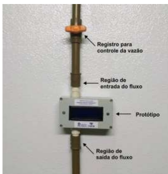
Figura 32. Instalação utilizada nos testes de precisão de leitura da vazão.
