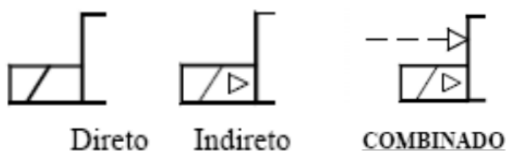
Figura 15. Representação de acionamentos elétricos por solenóide.
