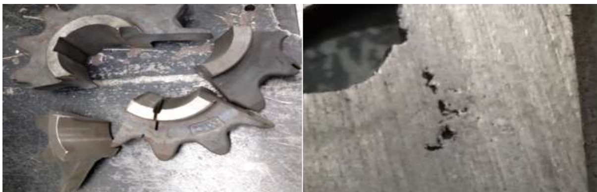
Figura 28 - Disponibilização do corte e a constatação da presença de micro porosidade
