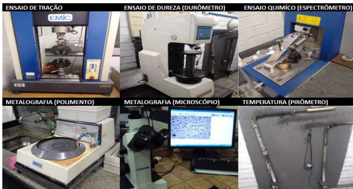
Figura 29 - Equipamentos utilizados para ensaios químicos e mecânicos
