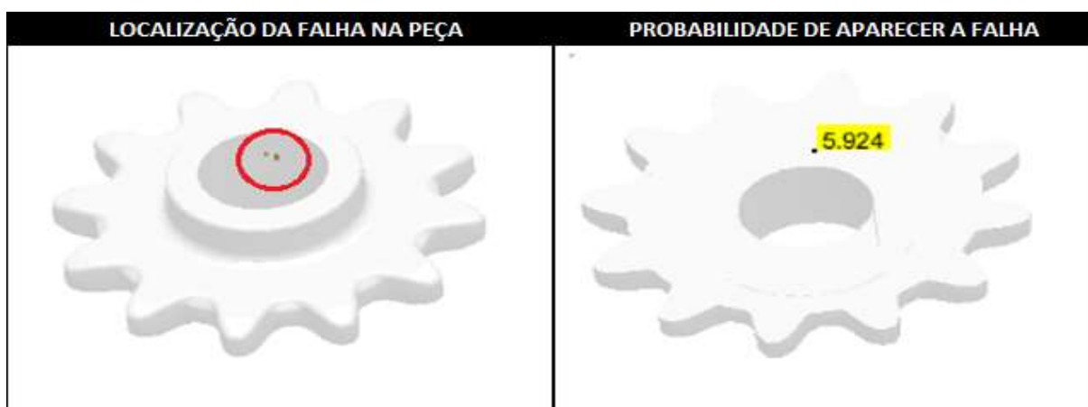
Figura 40 - Melhor design simulado pelo magma para eliminação da micro porosidade
