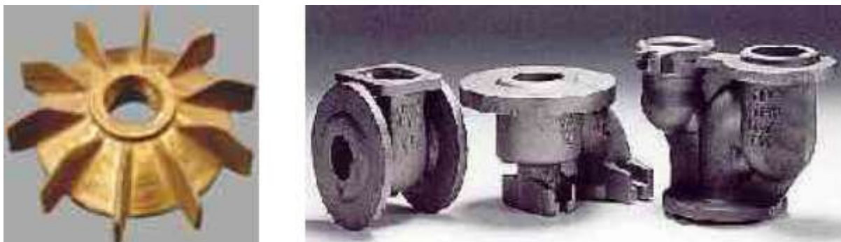
Figura 2 – Peças com cavidade produzidas por fundição
