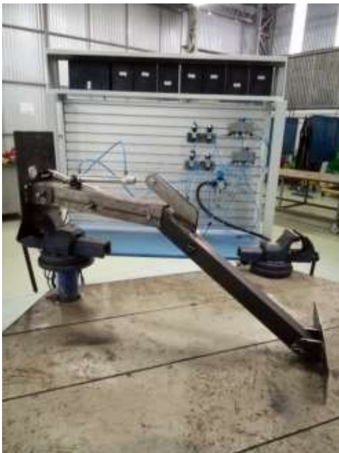
Figura 6: Teste do braço raspador mecânico através de bancada de acionamento pneumático.
