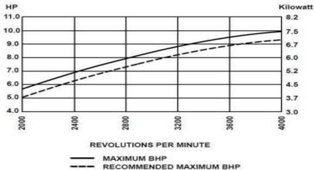
Figura 2: Potência x rotação do motor Briggs & Stratton 10HP
