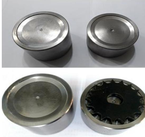
Figura 30: Protótipo da cavidade da ferramenta.
