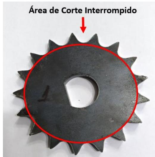
Figura 6: Usinagem com corte interrompido.
