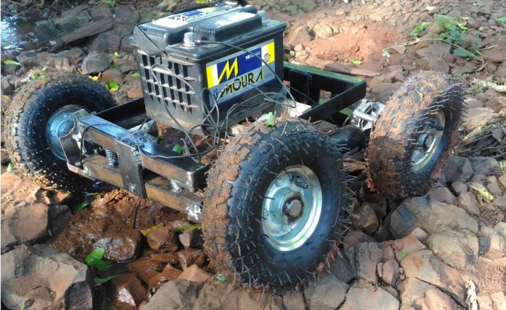
Ainda na condição de ambiente pedregoso, verificou-se que o protótipo de robô apresentou boas condições de mobilidade. Nota-se que, conforme apresenta a Figura 28 abaixo, na condição de grande desnível, mesmo que em ambiente com certa umidade, o protótipo é capaz de mover-se nesse tipo de ambiente.
