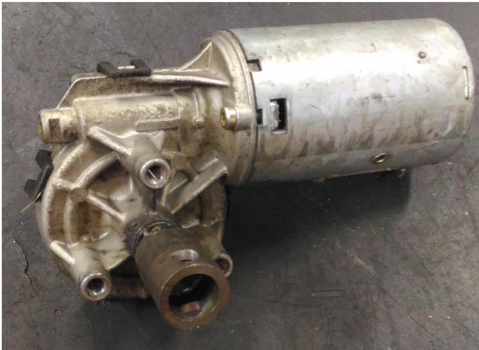
O principal motivo para a escolha deste motor se deve pela relação de custo-benefício. Outro fator que influenciou na escolha deste motor, é o fato de ser um motor de corrente contínua 12V, assim facilitando a instalação e funcionamento do protótipo.
