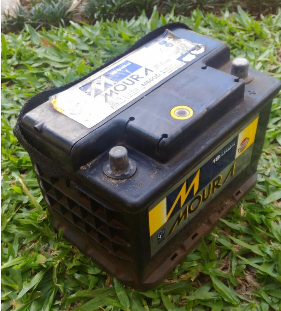
Em relação a fonte de energia foi realizada a escolha de utilizar uma bateria automotiva 12 V (Figura 19), sendo que está possui capacidade de 80 Ah. O sistema elétrico, é composto por uma bateria, quatro motores, uma botoeira de acionamento (Figura 20) e fios de 1,0 milímetro de diâmetro.
