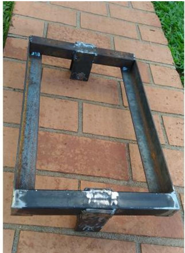
Esses perfis foram soldados (no laboratório de soldagem da FAHOR) através do processo MAG (processo mais utilizado na união de materiais ferrosos)
