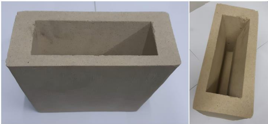
Figura 13 - Molde em areia confeccionado pelo processo Flexicore
