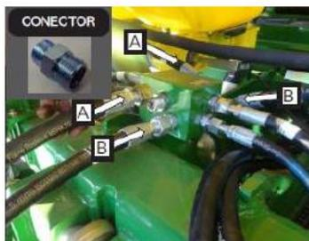
(2°) Retirar as mangueiras "A" e usar o conector em destaque. Posteriormente fazer as ligações com as mangueiras "B" da mesma forma, usando outro conector.
