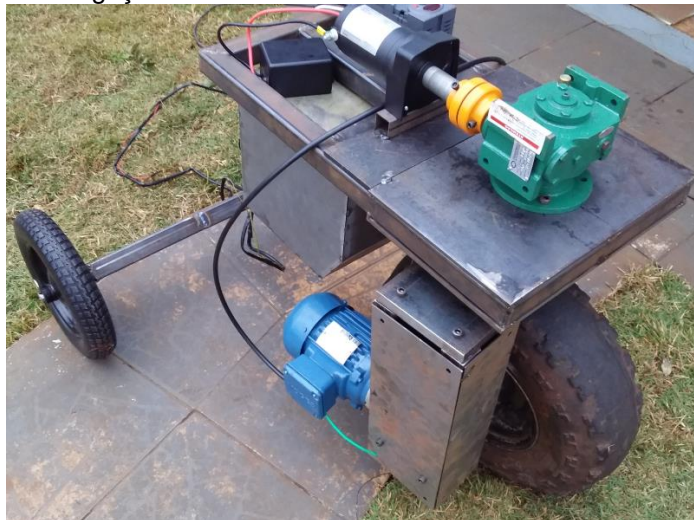
Figura 57: Protótipo com a ligação elétrica dos motores e inversor.
