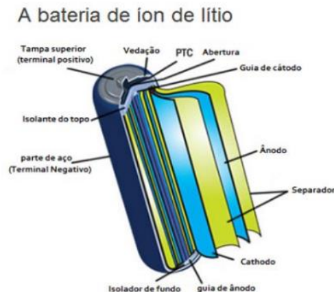
Figura 21: Composição da bateria de Lítio.
