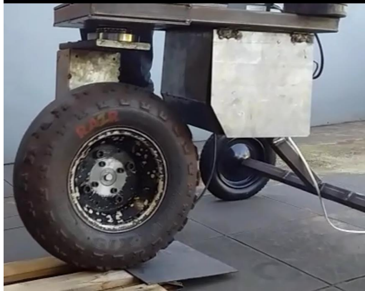
Figura 58: Protótipo em aclave improvisado de 10°.
