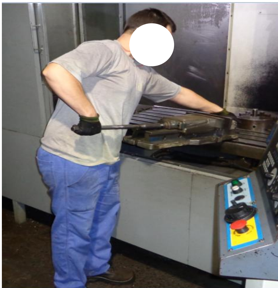
Figura 21 - Posicionamento da morsa sobre a mesa da fresadora
