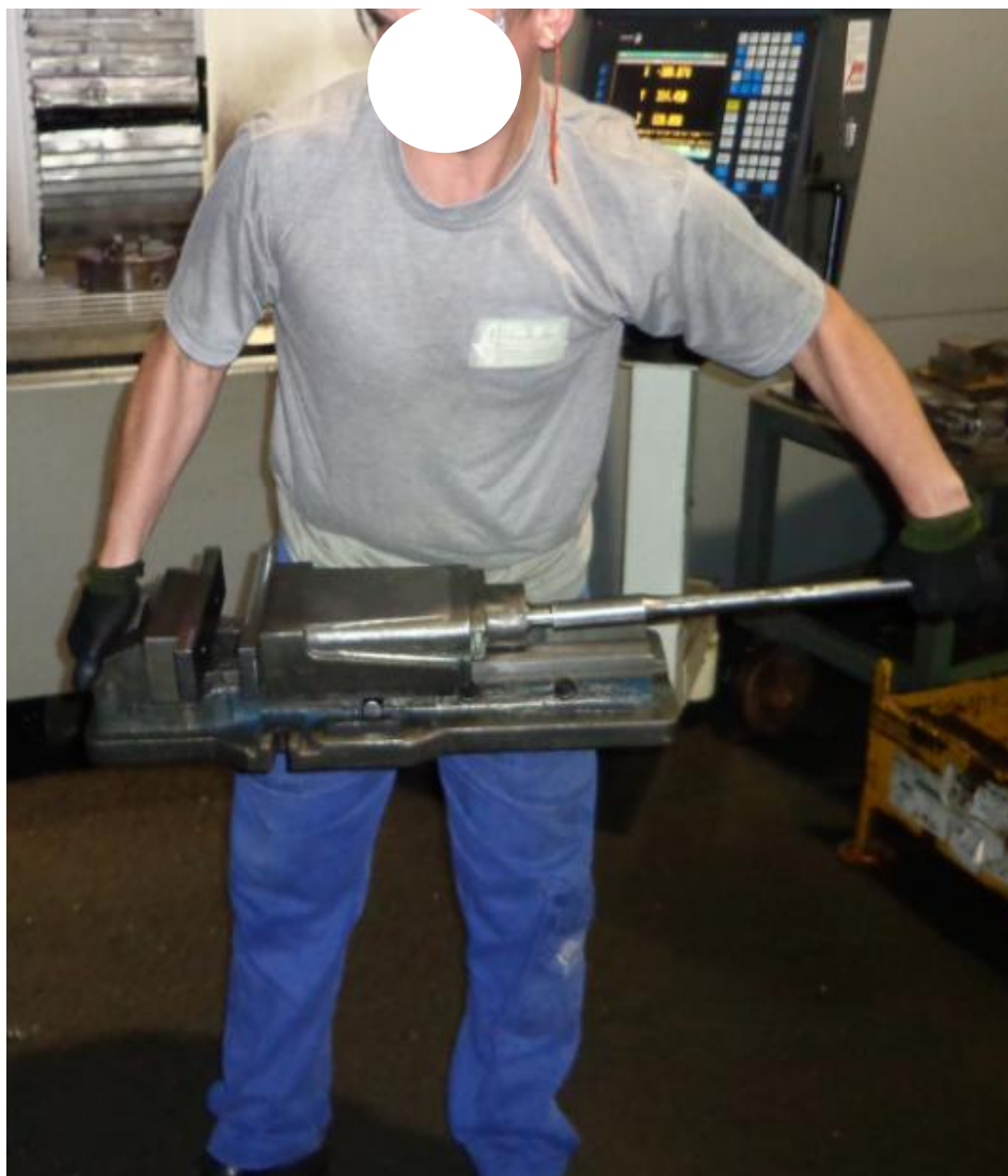
Figura 17 - Postura do operador para conduzir a morsa até a mesa da fresadora
