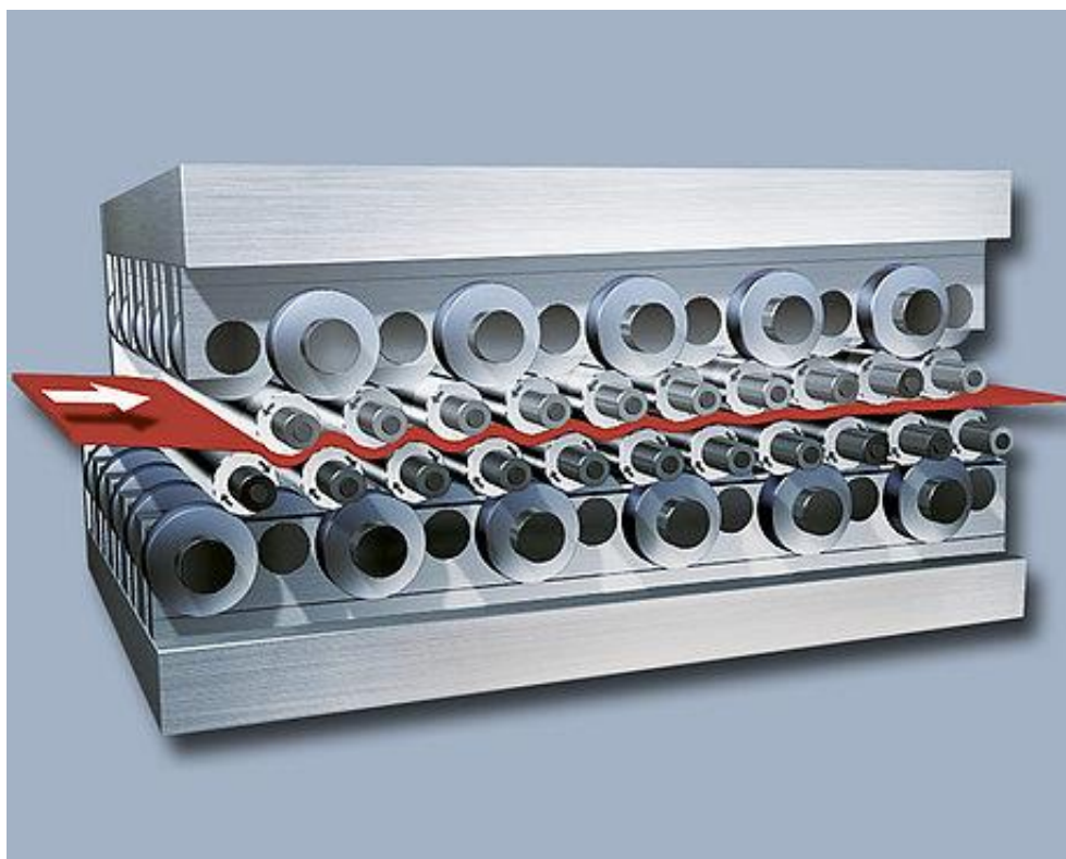
Figura 3- Imagem de desempenamento por cilindro.
