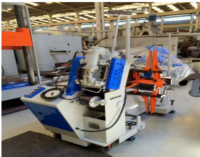
Figura 6- Imagem de desbobinadora e endireitador SCHULER modelo AHR 250/2
