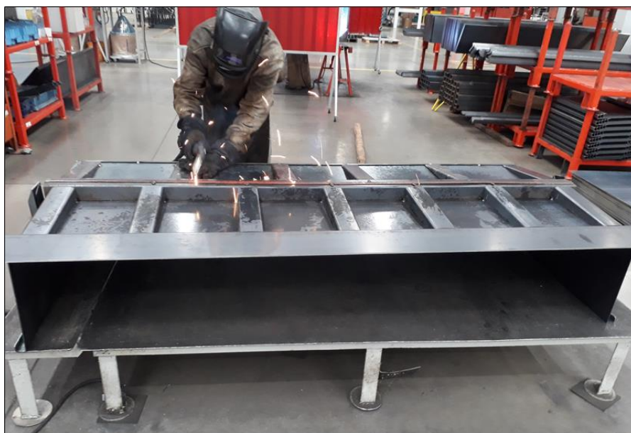
Figura 5: Ponteação do conjunto
