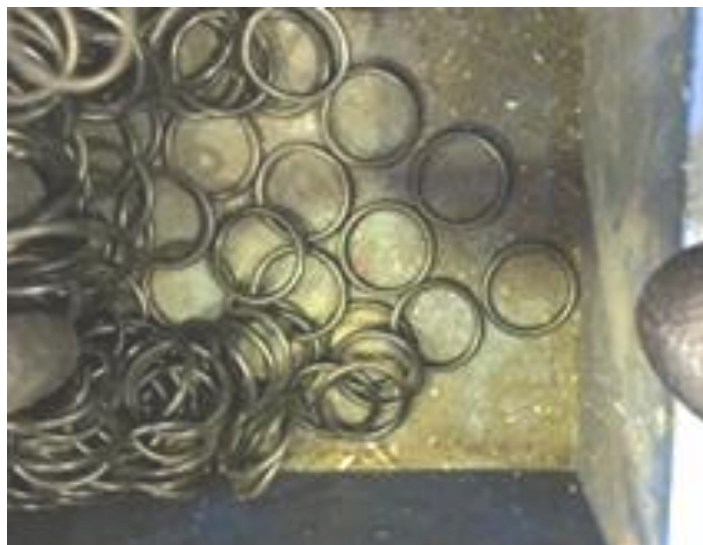
Figura 2 – Anel o-ring com contaminantes
