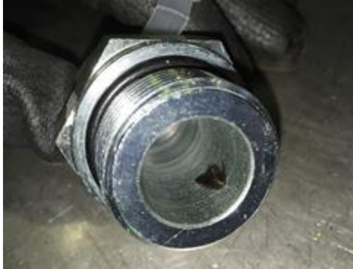
Figura 1 – Conexão com contaminantes
