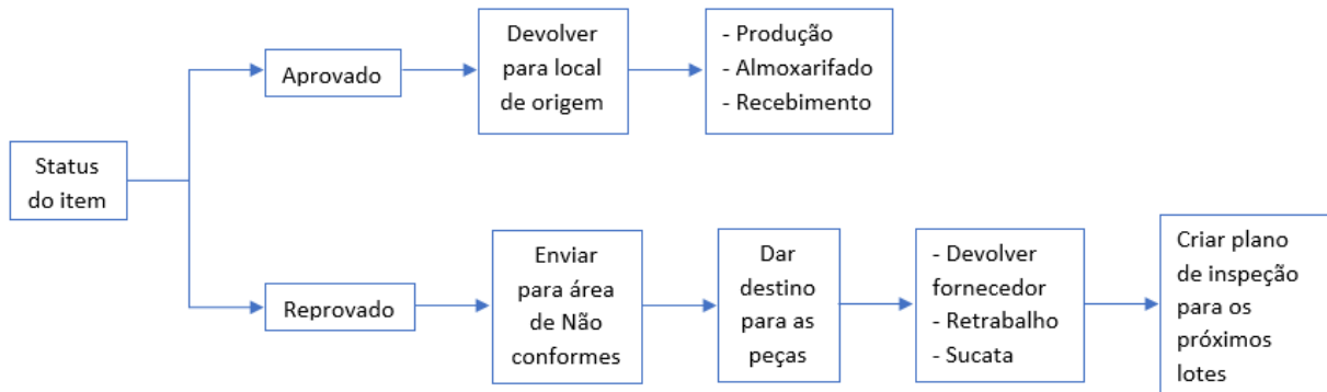
Figura 20 – Fluxograma de disposição após análise gravimétrica
