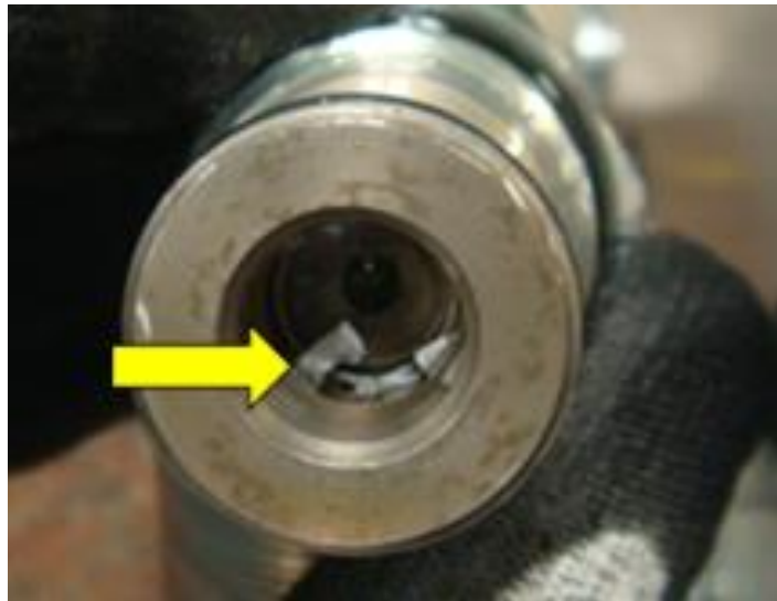
Figura 3 – Válvula com contaminantes
